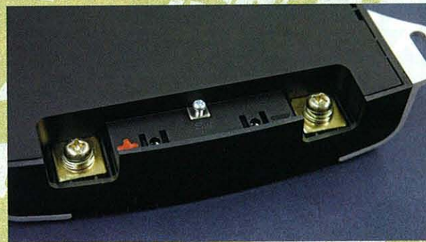
裏側に電源端子が設定されている。普段はカバーに覆われ、ショートなどの危険を排除。
